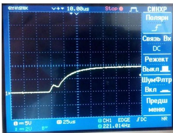
Рисунок 3.6 – Осциллограмма: 1 канал – напряжение затвор-исток транзистора
