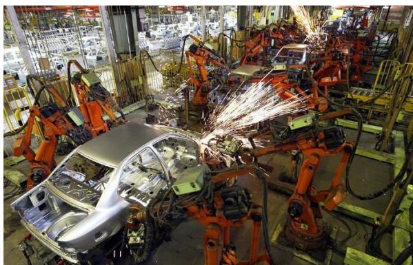
Рисунок 1 – Сварка кузовов легковых автомобилей при помощи промышленных манипуляторов
