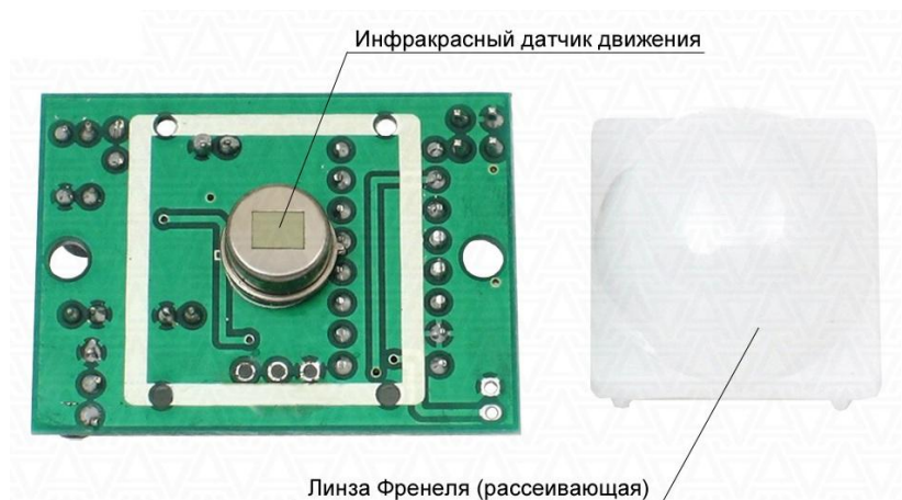
Рисунок 17- PIR-датчик HC-SR501 со снятой линзой Френеля
