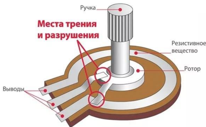
Рисунок 39 – Потенциометр, использующийся в сервоприводах
