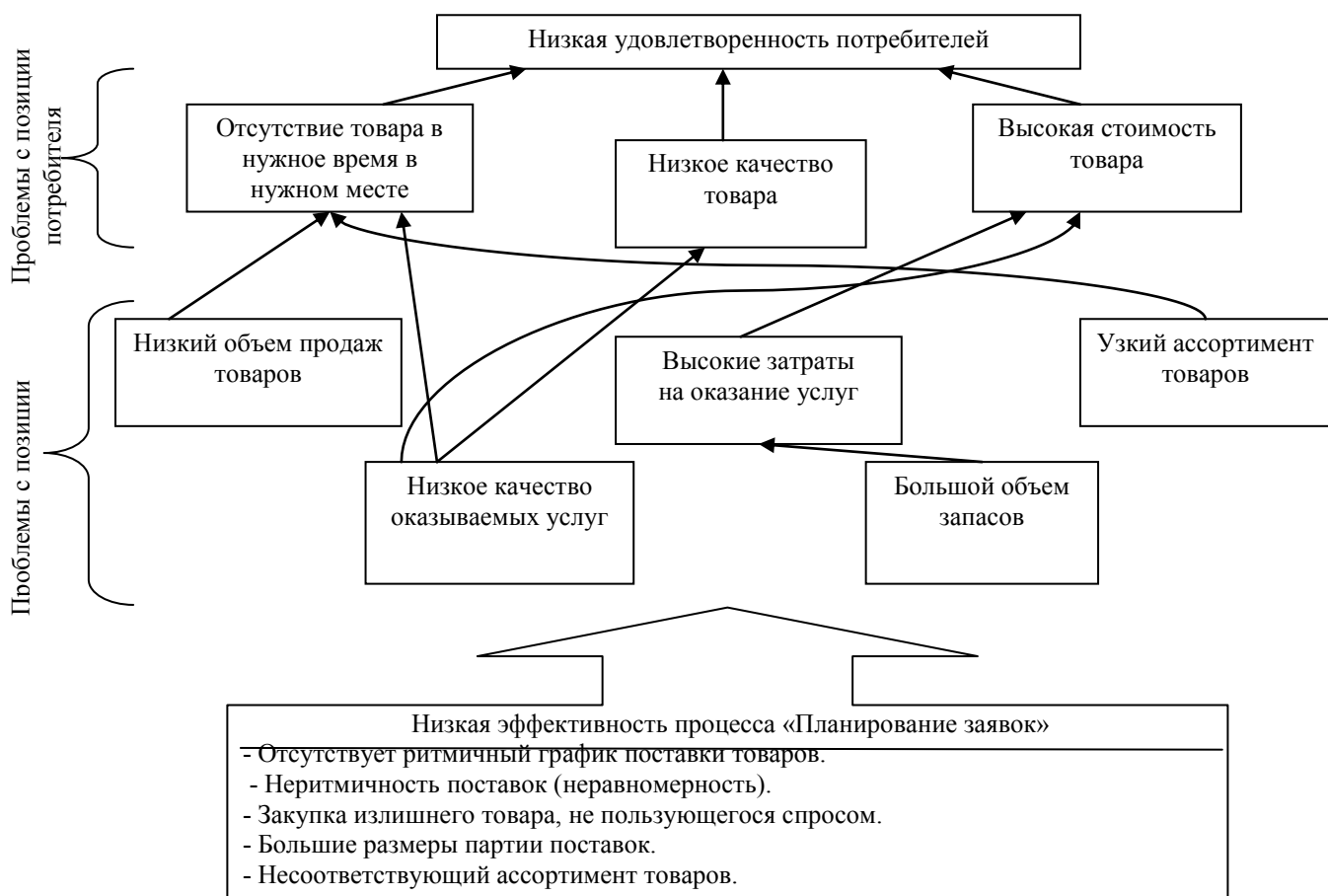
Рисунок 2.2 – Схема взаимосвязи проблем процесса «Планирование заявок»
