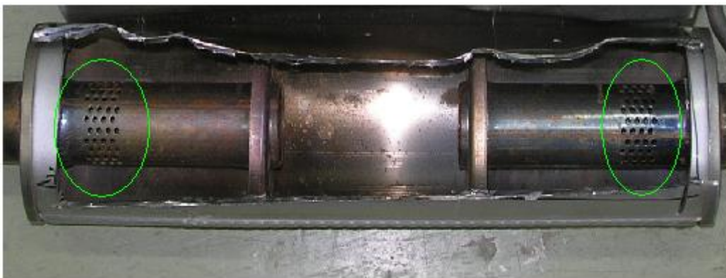
Рисунок 22 – Правильное расположение перфорированной трубы
