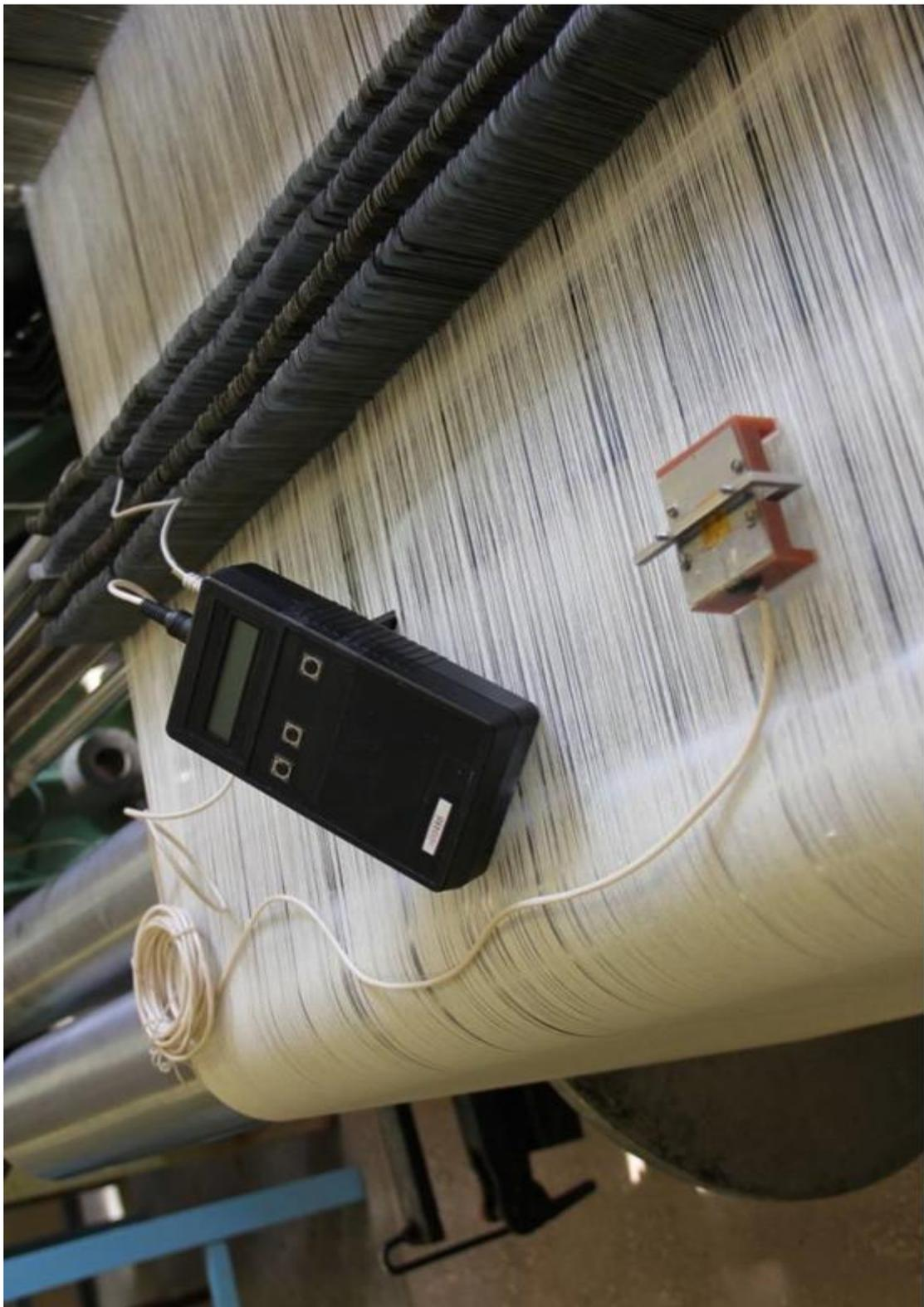
Рисунок 32 – Блок электронный прибора «ТПП-2008».
