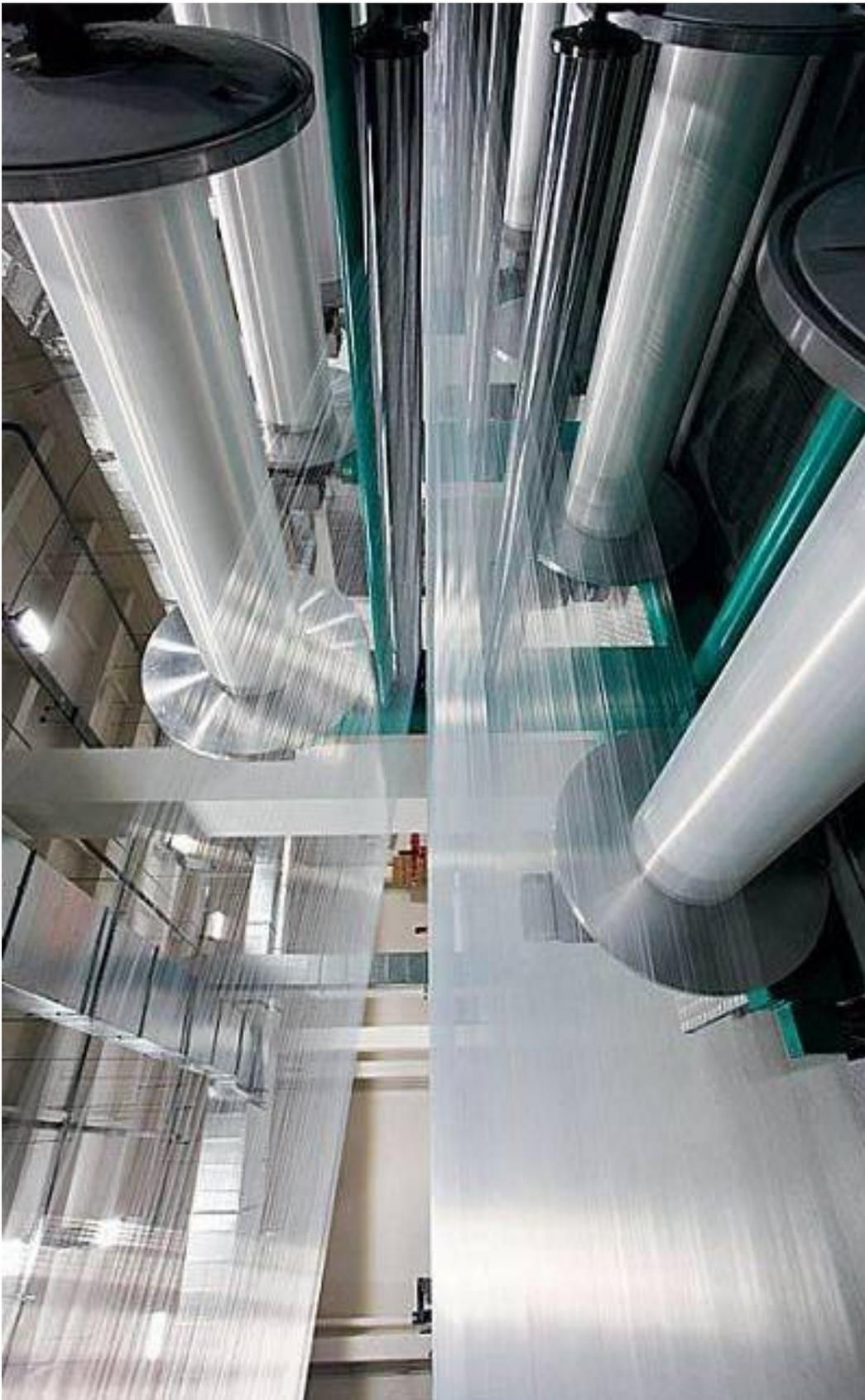
Рисунок 34 – Процесс шлихтования
