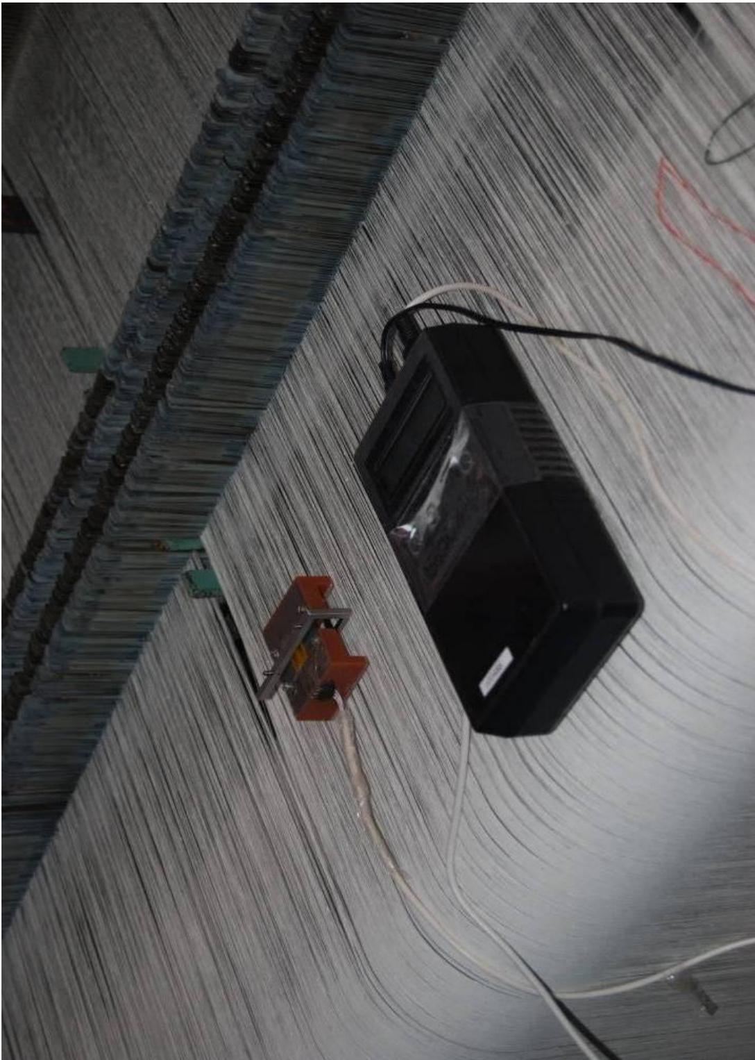
Рисунок 29 - Блок электронный прибора «ТПП-2008», датчик измерения натяжения нитей
