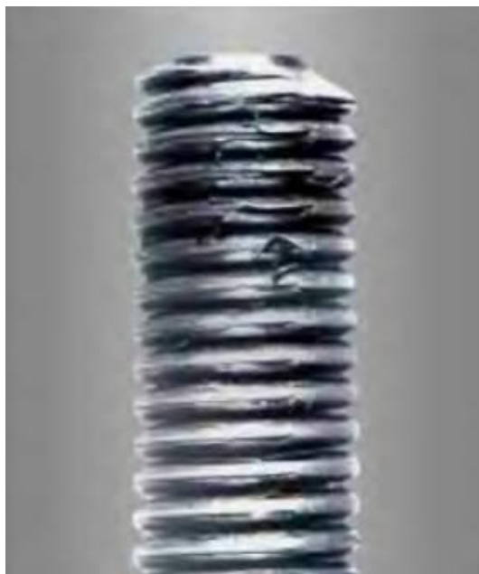
Рисунок 3.22 – Отслоение на участке резьбы при накатывании в месте нанесения риски на заготовку
