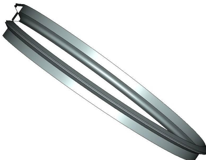
Рисунок 3.21 – Определение диаметра заготовки под накатывание резьбы M20x1,5 с помощью 3D моделирования.
