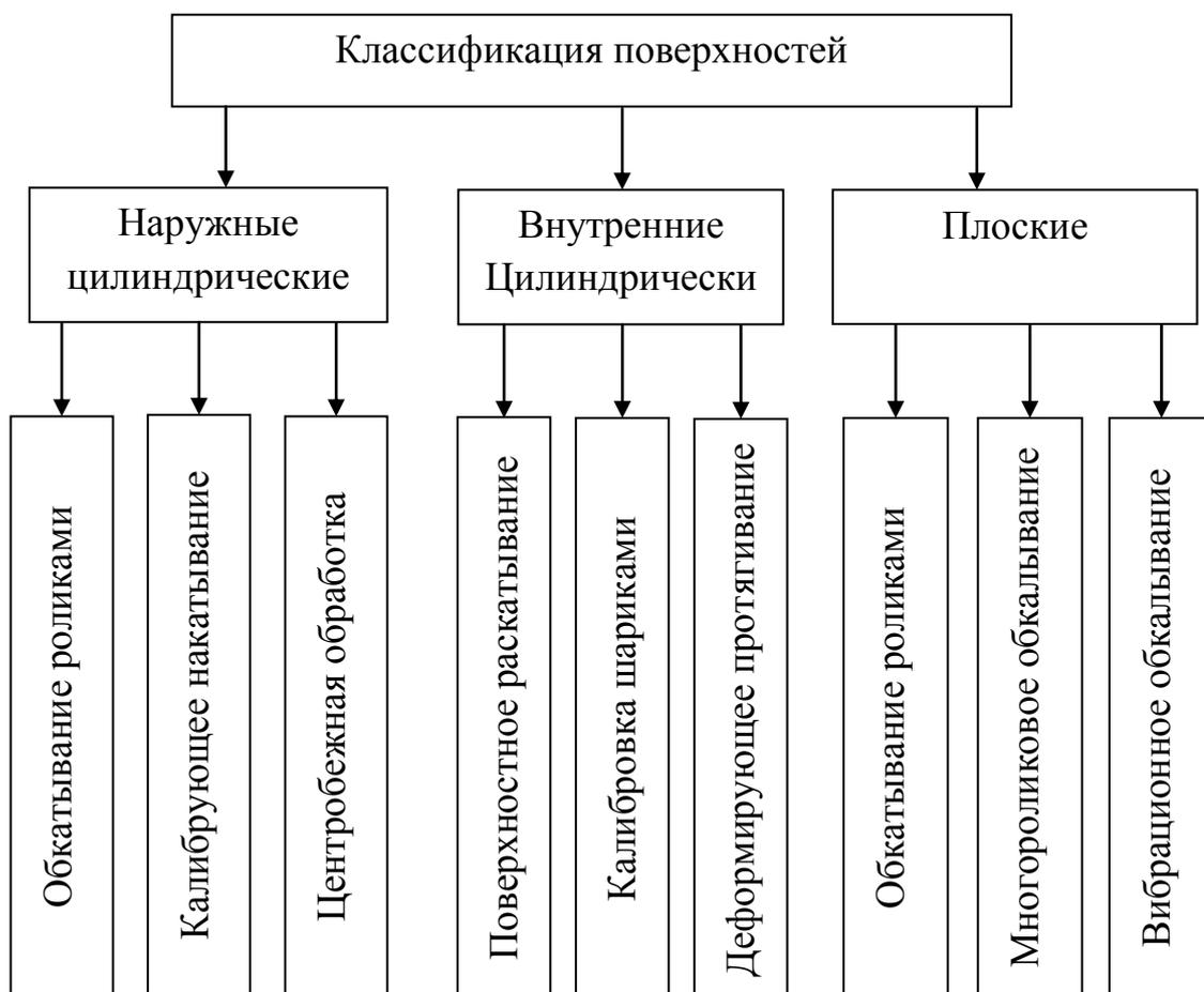
Рисунок 1.2. – Классификация приспособлений по способам обработки поверхностей.
