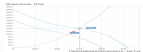
Рисунок 4.6- Характеристика вентилятора ТТ 160
