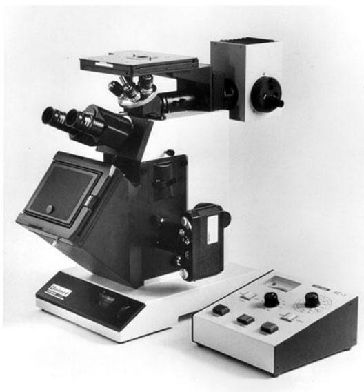
Рисунок 12 - Световой микроскоп Unimet 8585
