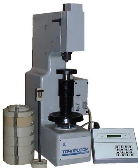
Рисунок 13 - Твердомер ТБ 5004
