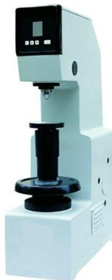
Рисунок 9 – Твердомер HB-3000B [5]
