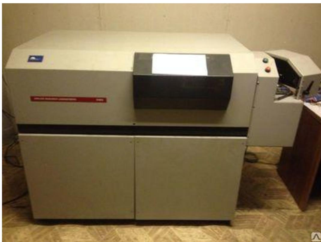
Рисунок 7 – Оптико-эмиссионный спектрометр Quantovak ARL 2460
