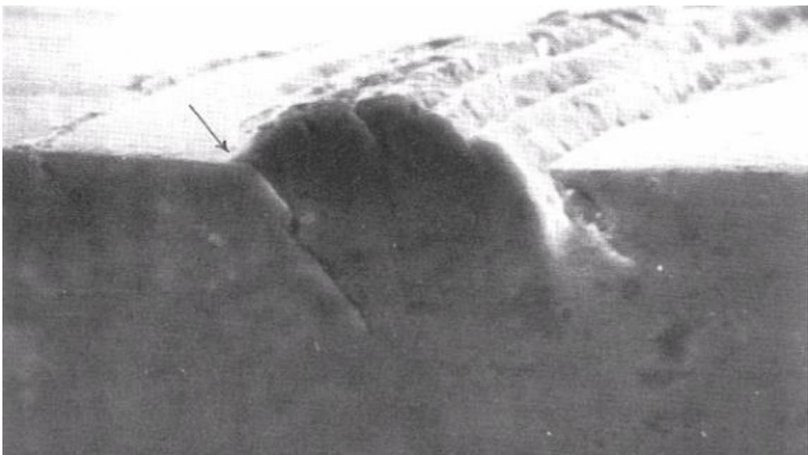
Рисунок 1.4- Устойчивые полосы скольжения и зародышевая трещина в Cu-кристалле
