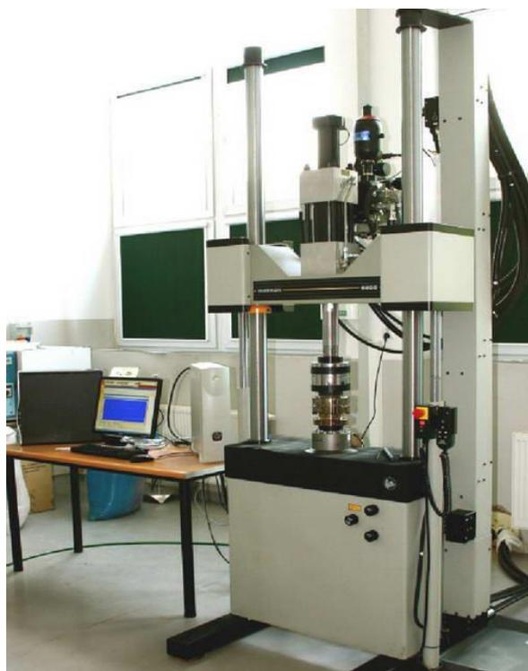
Рисунок 2.1 – Система Instron 8802 для усталостных испытаний
