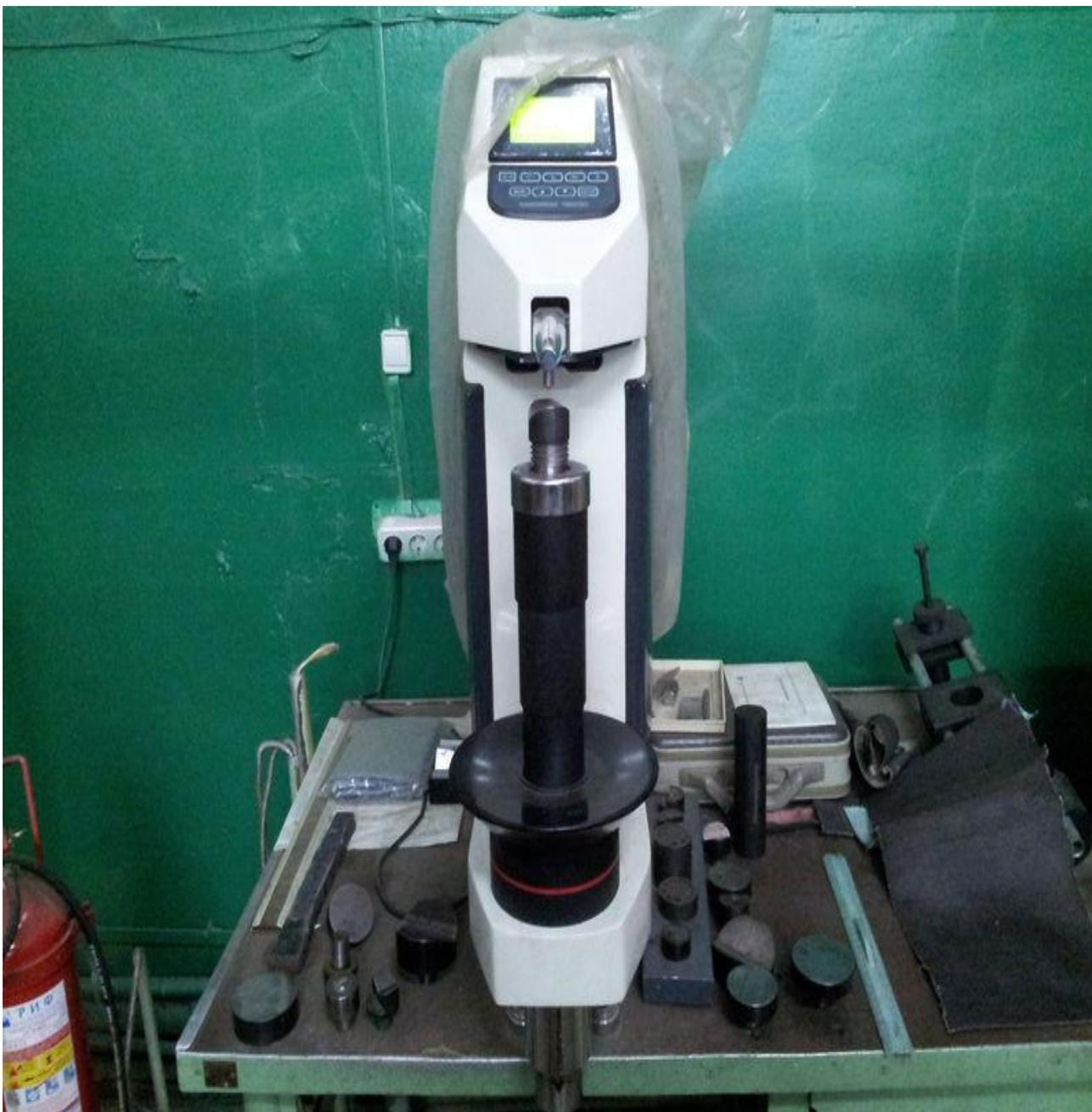
Рисунок 2.4 – твердомер ТН-300.
