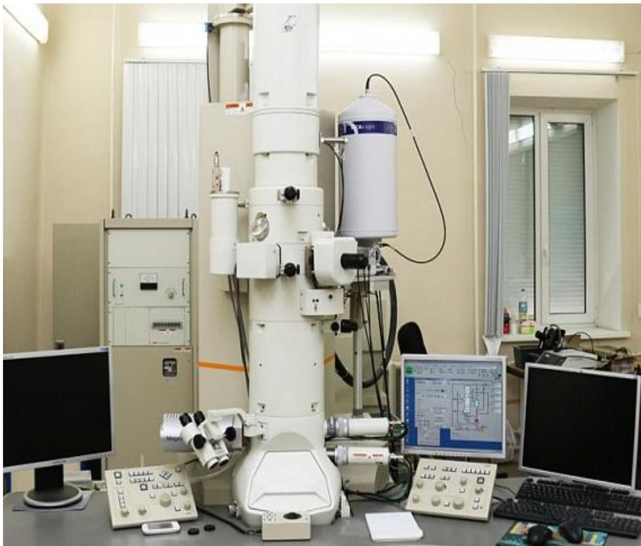
Рисунок 2.3 – JEM-2100F универсальный 200кВ просвечивающий электронный микроскоп с термополевой пушкой Шоттки.
