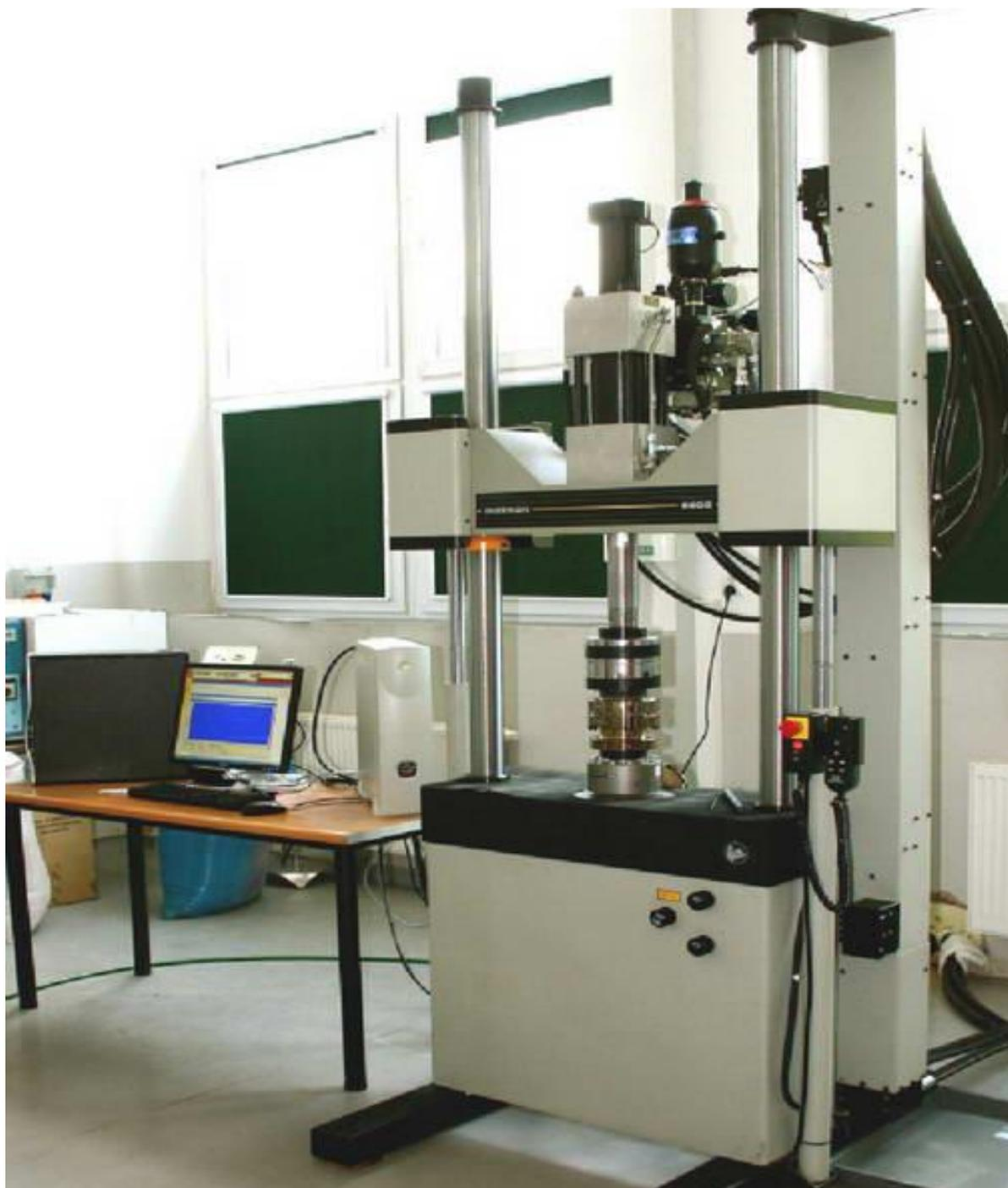
Рисунок 2.7 – Сервогидравлическая испытательная машина INSTRON 8802.
