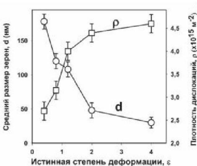
Рисунок 1.7 – График зависимости среднего размера зёрен и плотности дислокаций от истинной степени деформации. [17]
