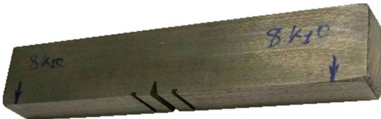
Рисунок 2.2 – образец изготовленный в соответствии с ГОСТ 25.506-85 [25] для проведения испытания по определению статической трещиностойкости.
