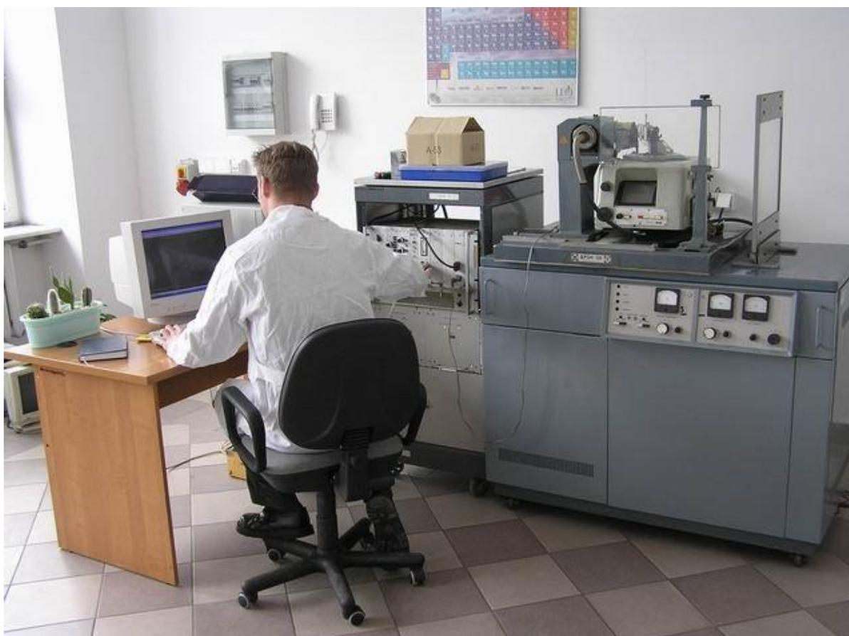
Рисунок 2.10 – Рентгеновский аппарат ДРОН-2,0
