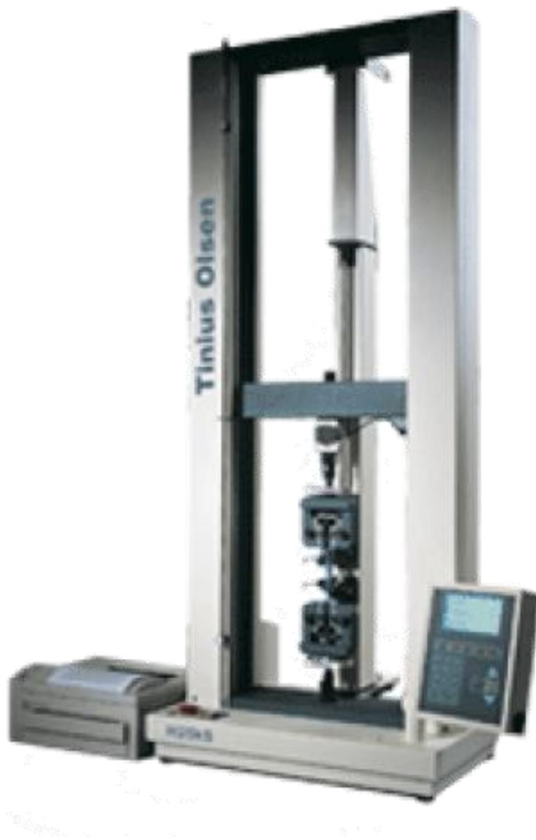
Рисунок 2.5 – Разрывная машина Tinius Olsen H50КТ с нагрузкой до 5 тонн (50кН).
