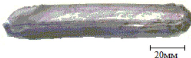
Рисунок 2.1 – Заготовка (сталь 45 прошедшая РКУП)
