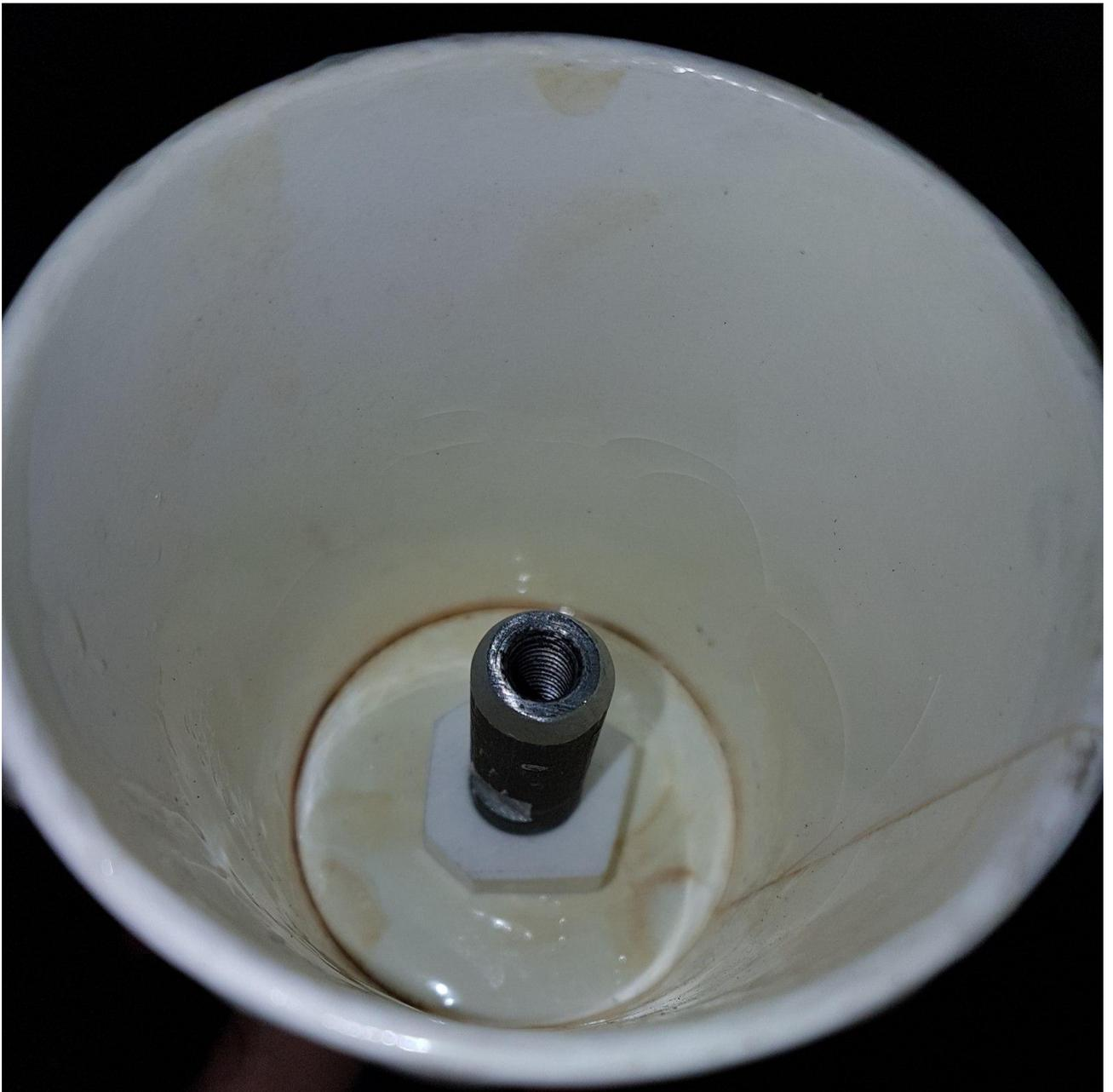
Рисунок 2.6 – сосуд для удержания жидкого азота, изготовленный из стакана под кофе.
