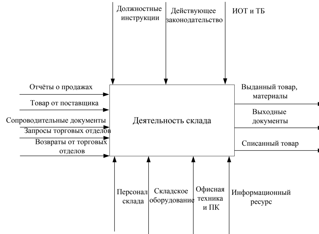
Рисунок Б.1 - Модель процесса складирования товара
