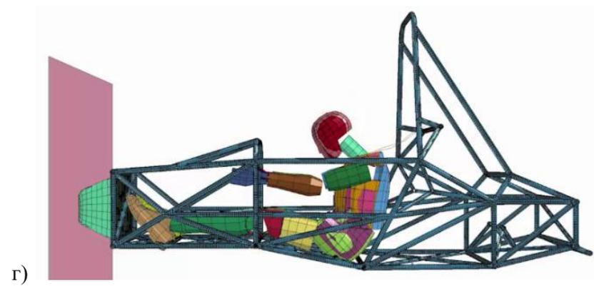
Рисунок 1.7 - Моделирование столкновения с энергопоглощающим элементом
