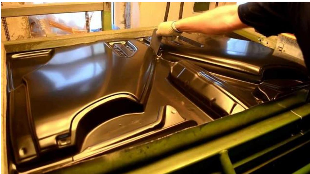
Рисунок 1.1 – Изготовление средних облицовочных деталей автомобиля, методом штамповки.
