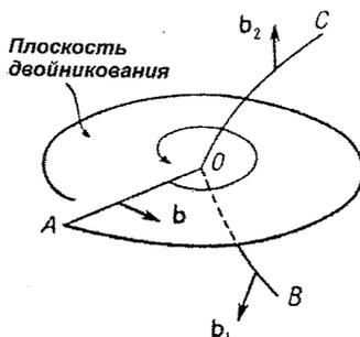
Рис. 3.4. Полюсный механизм образования двойника
