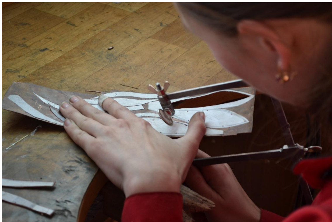
Рисунок Д 1. Выпиловочный процесс деталей портбукета и бутоньерки. ДПИ-1301, Калмыкова А.2017год
