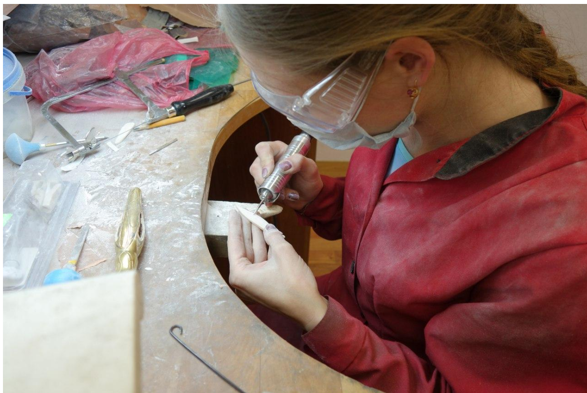
Рисунок Д3. Процесс изготовления вставок из рогов козы. ДПИ-1301, Калмыкова А.2017год
