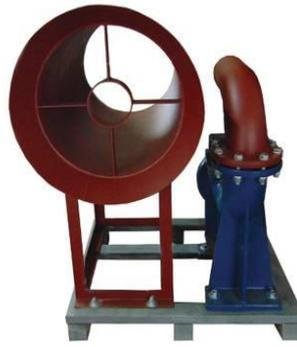
**Рисунок 2 - Гидроэжектор**
