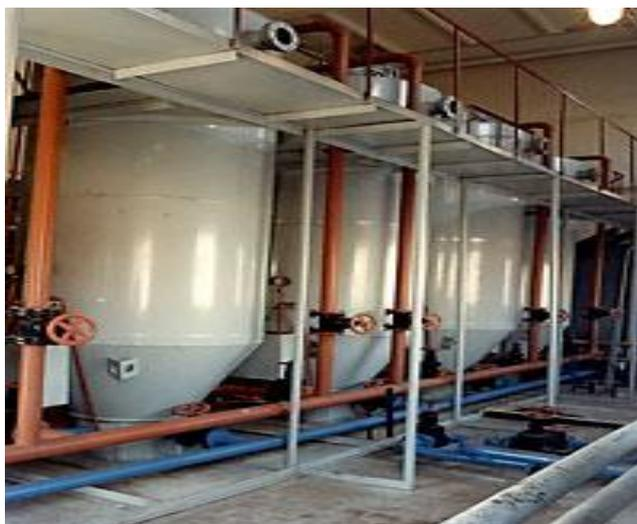
**Рисунок 4 -Трехступенчатый блок фильтров**
