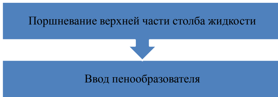
Рисунок7 - Этапы по удалению жидкости из ствола скважины
