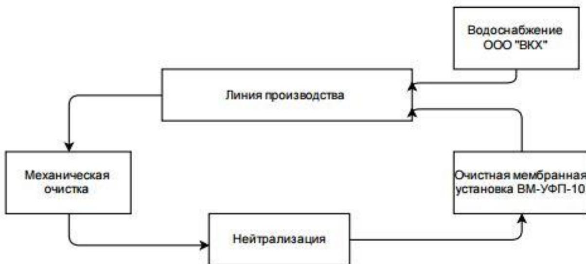
**Рисунок 28 – Схема водооборотного цикла с мембранной установкой ВМ-УФП-10**
