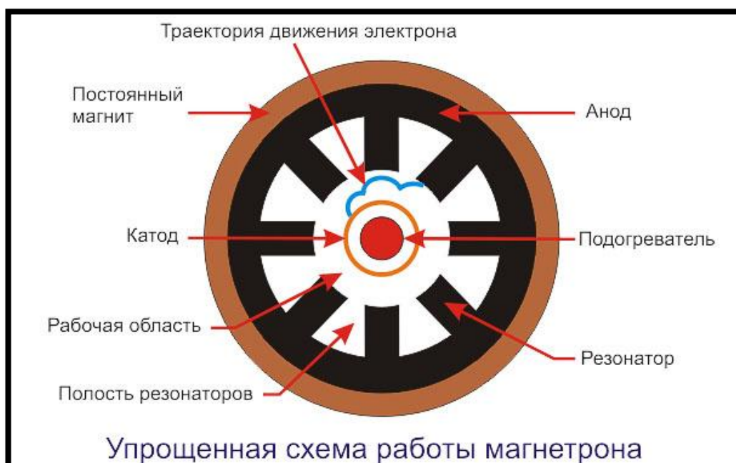
Рисунок 12 – Упрощённая схема работы магнетрона
