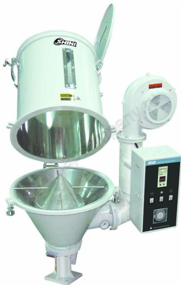
Рисунок 15 Бункер сушилка SHD производства фирмы Shini
