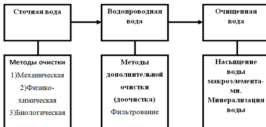
Рисунок 1.2.1 – Этапы получения высококачественной воды
