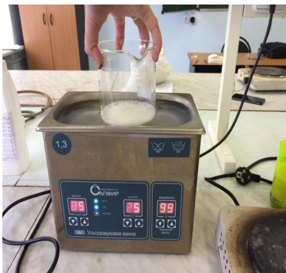
**Рисунок 12 - Стакана с парафиновой эмульсией в ультразвуковой ванне**
