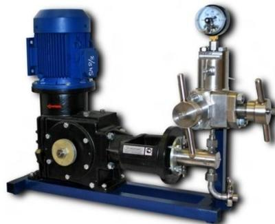
**Рисунок 15 - Клапанный гомогенизатор**
