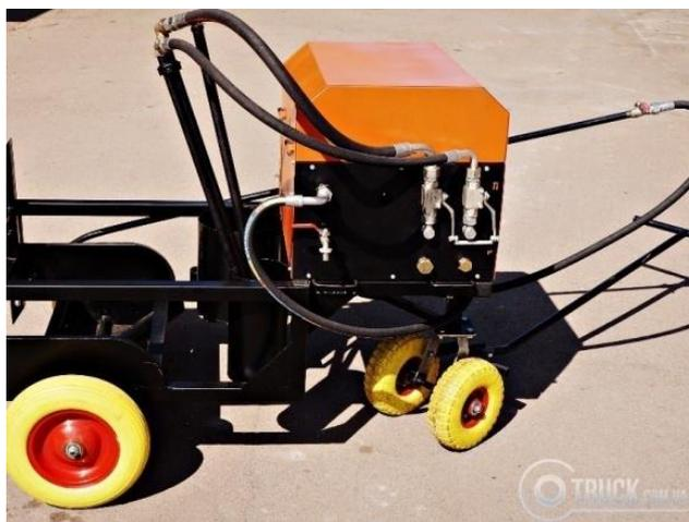
**Рисунок 18 – Ручной распылитель**
