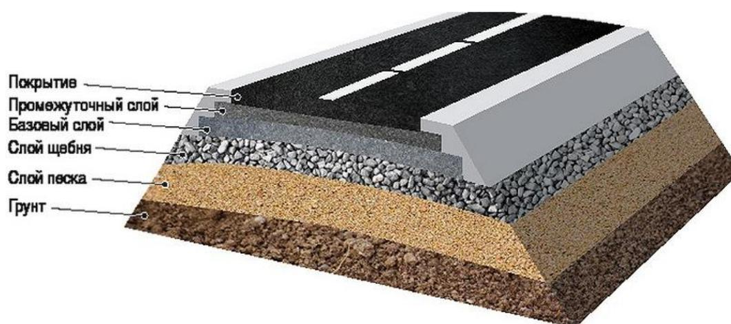
Рисунок 1 - Состав дорожного покрытия
