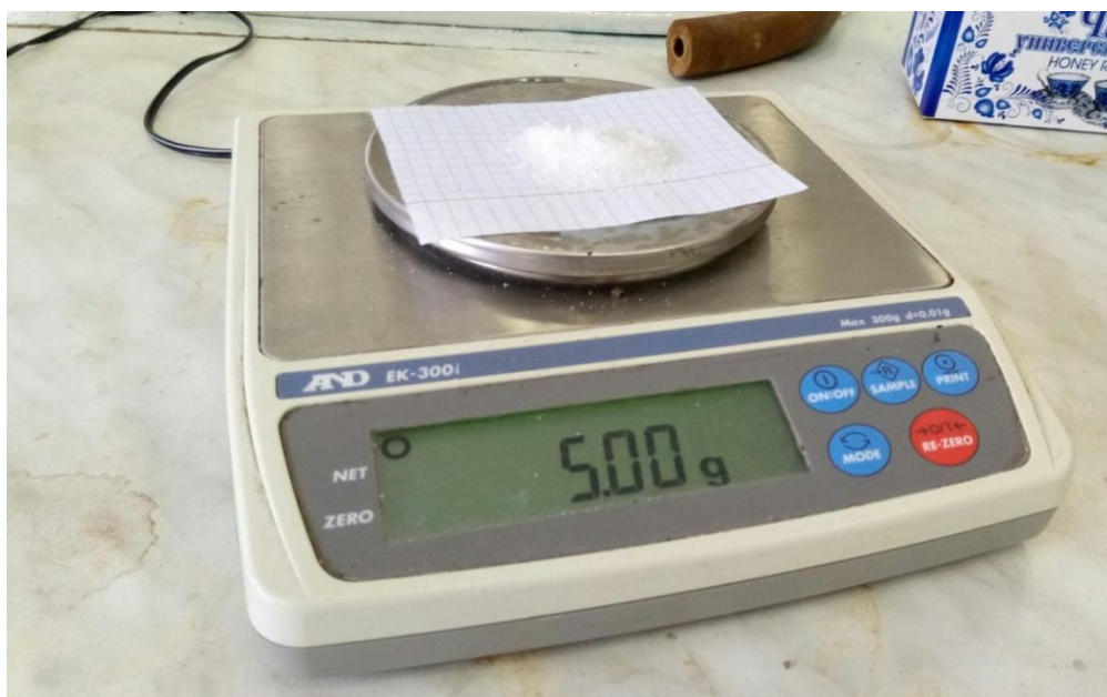
Рисунок 10 - Навеска 5г.NaCl на технических весах
