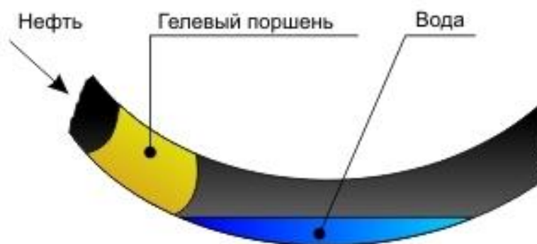
Рисунок 8 – Прохождения гелевого поршня в полости трубопровода
