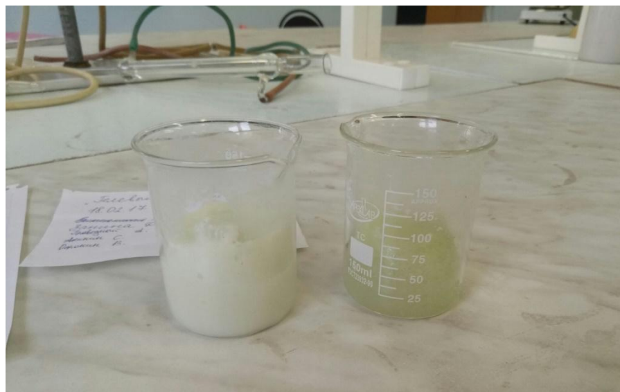
Рисунок 18 - Готовые гелевые поршни экспериментов №1 и №2
