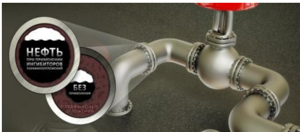
Рисунок 5 – Состояние трубопровода с применением ингибитора и без применения ингибитора
