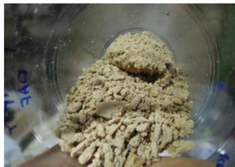
Рисунок 51 - Фотография кека полученного с установки шнекового обезвоживания, при минимальном расположении прижимной гайки (расстояние между прижимной гайкой и выходом со шнека – 4 мм)
