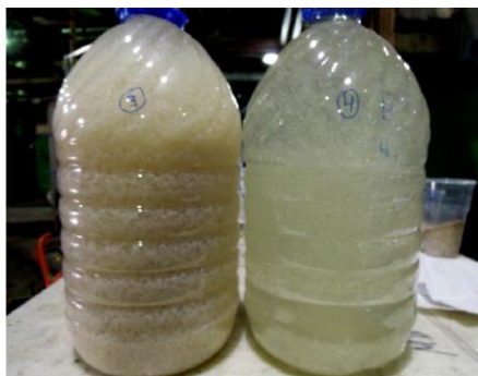
Рисунок 52 - Фото проб с узла обезвоживания флотошлама: слева флотошлам обработанный реагентом, справа - фильтрат
