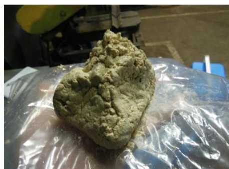
Рисунок 50 - Фотография кека полученного с установки шнекового обезвоживания, при оптимальном расположении прижимной гайки (расстояние между прижимной гайкой и выходом со шнека – 8 мм)
