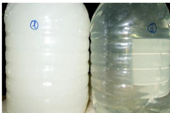
Рисунок 45 - Фотография проб с узла физико-химической очистки (первая ступень), слева – исх. сток, справа – фильтрат
