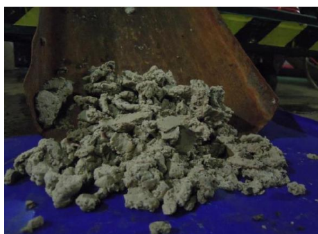
Рисунок 50 - Фотография кека полученного с установки шнекового обезвоживания, при оптимальном расположении прижимной гайки (расстояние между прижимной гайкой и выходом со шнека – 8 мм)
