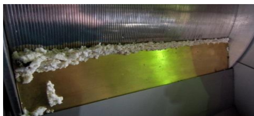
Рисунок 36 - Внешний вид каучуковой крошки, отделяемый на узле механической фильтрации.
