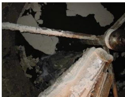
Рисунок 37 - Слой каучука на поверхности в емкости
