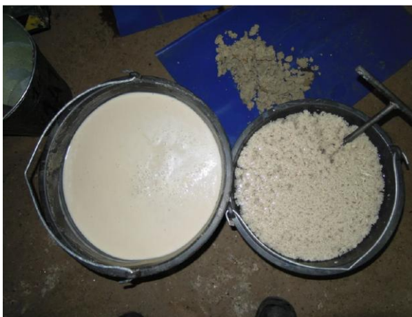
Рисунок 48 - Фотография проб с узла обезвоживания: исходный флотошлам (слева), обработанный флокулянтом флотошлам (справа)
