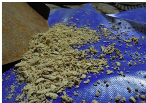
Рисунок 51 - Фотография кека полученного с установки шнекового обезвоживания, при минимальном расположении прижимной гайки (расстояние между прижимной гайкой и выходом со шнека – 4 мм)
