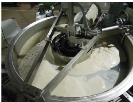
Рисунок 46 - Фотография флотошлама на поверхности установки при очистке воды после второго вибросита
