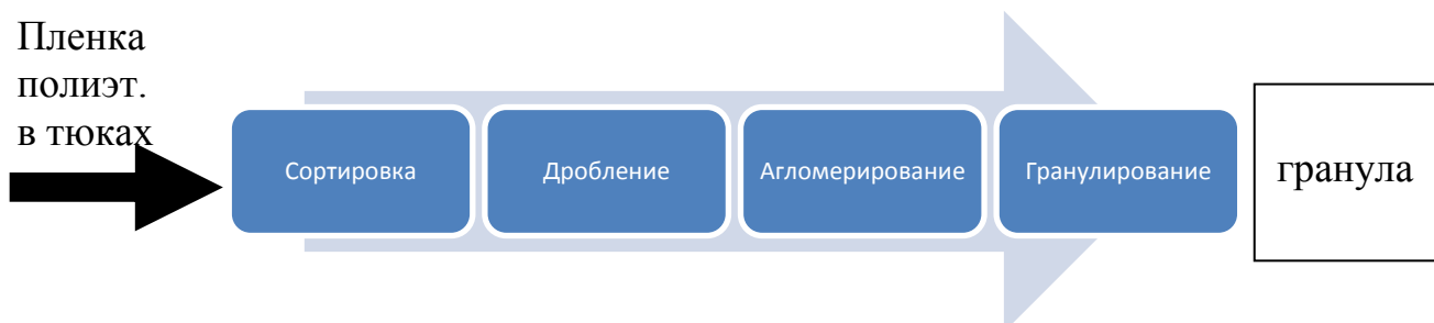
Рисунок 7- технологический процесс переработки полиэтиленовых пакетов.
