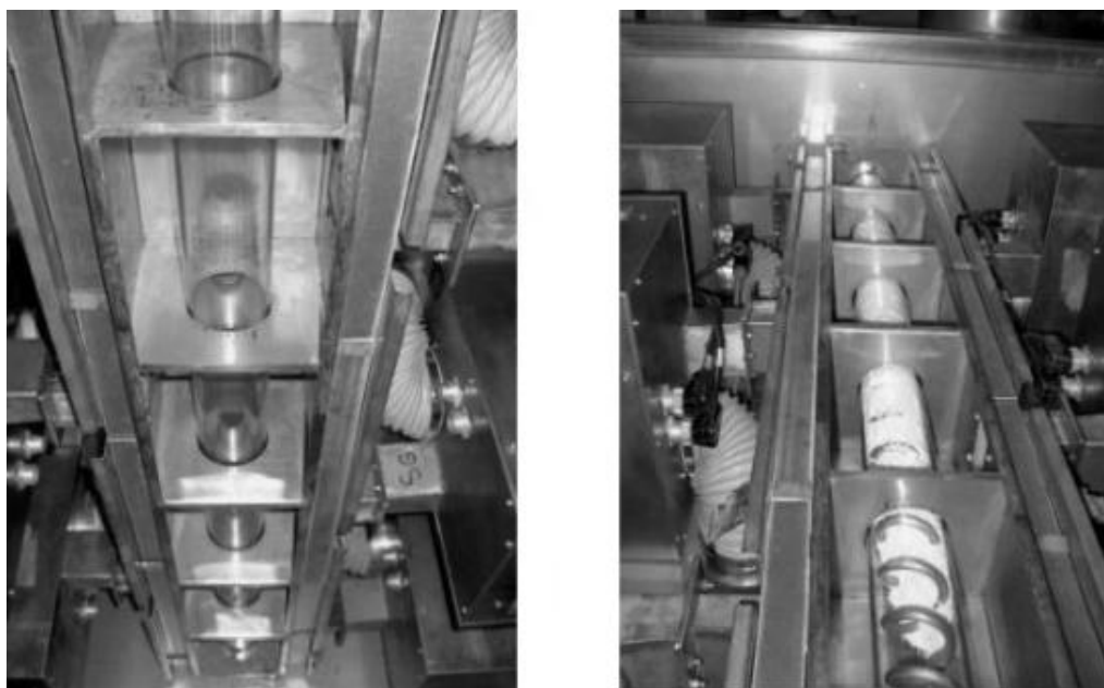
Рисунок 1.7 - Общий вид системы Thermostar. Шесть последовательных СВЧ устройств, связанных с вертикальной трубой (слева) и горизонтальной (справа)
