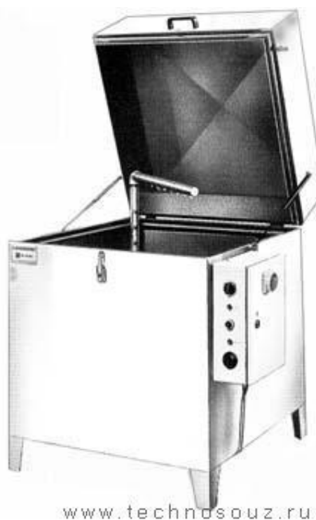
Рисунок 2.4 – Установка для мойки деталей L-90
