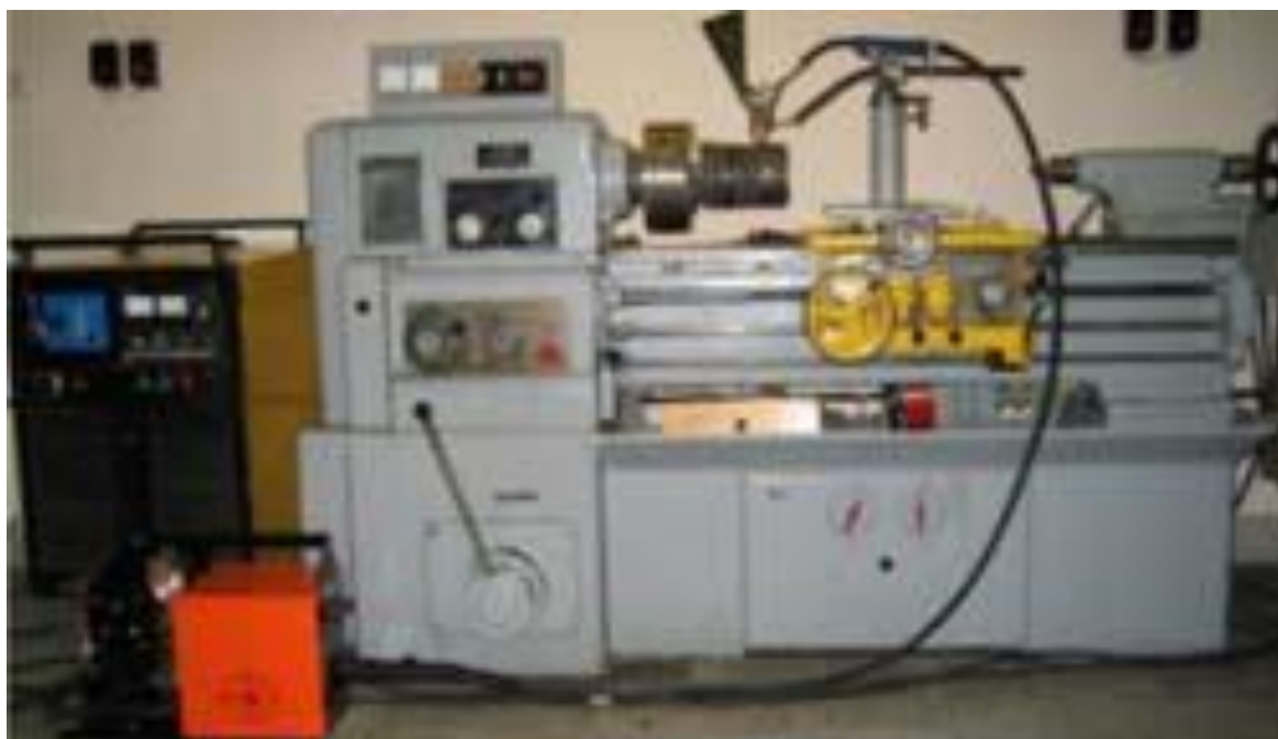
Рисунок 2.3 - Устройство наплавки валов якорей тяговых электродвигателей
