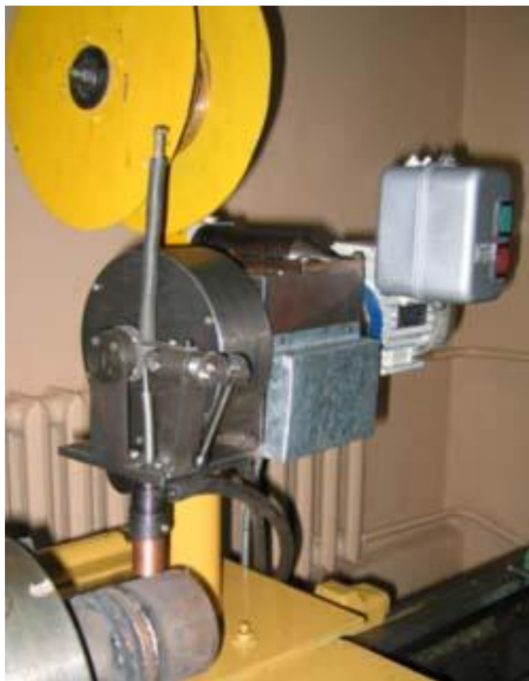
Рисунок 2.2 - Оборудование для вибродуговой наплавки деталей типа «вал» [22].
