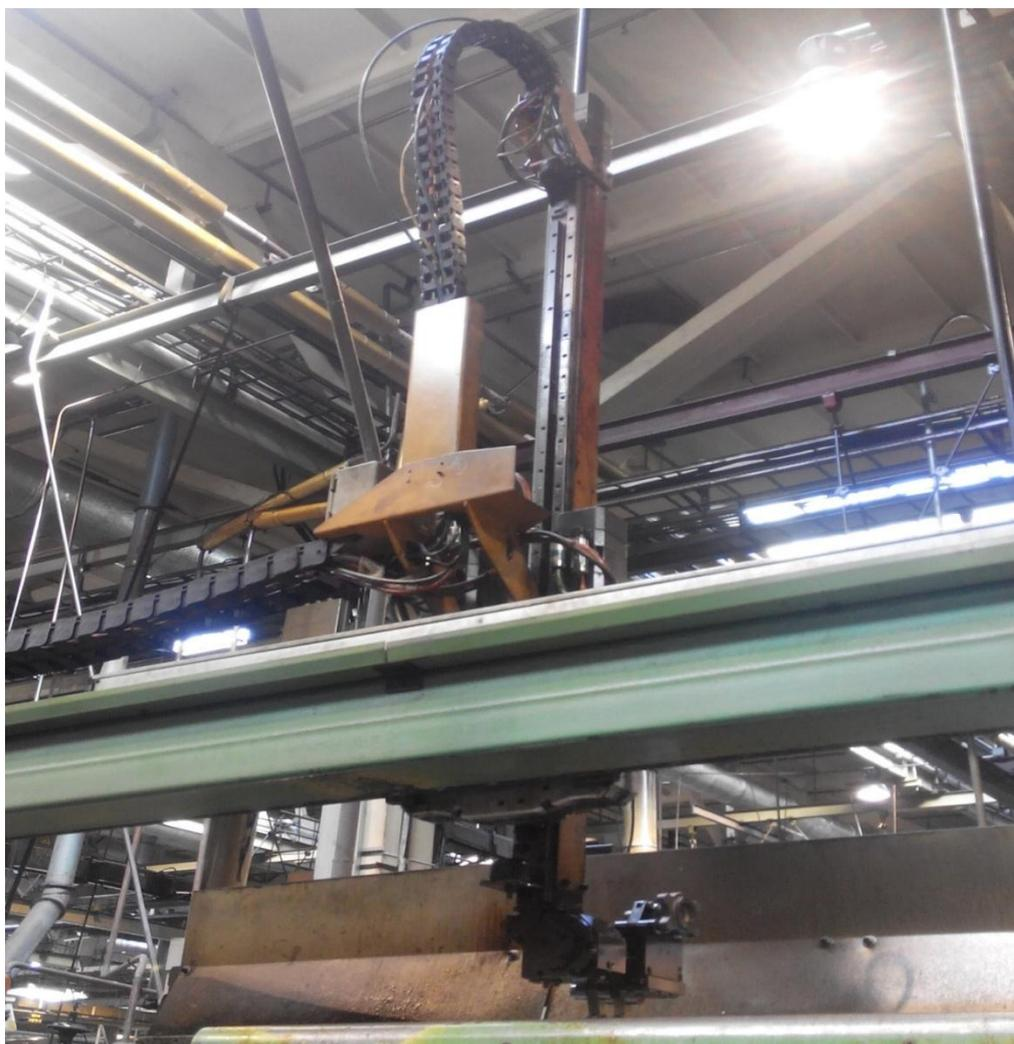
Рисунок1.2 - Портальный манипулятор с одной грузонесущей рукою, оборудованный грейферной головкой производства ПТО “АВТОВАЗ”
