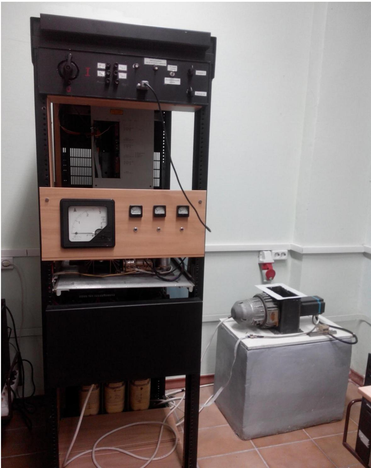
Рисунок 3.5 - Внешний вид лабораторного стенда с преобразователем Simodrive 610
