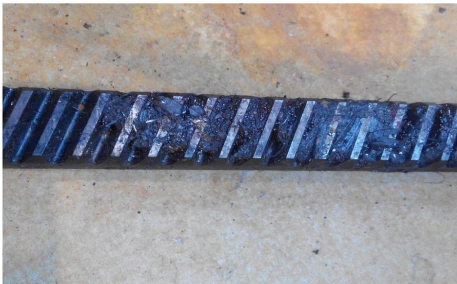
Рисунок 1.12 - Сегмент загрязненной направляющей со следами износа
