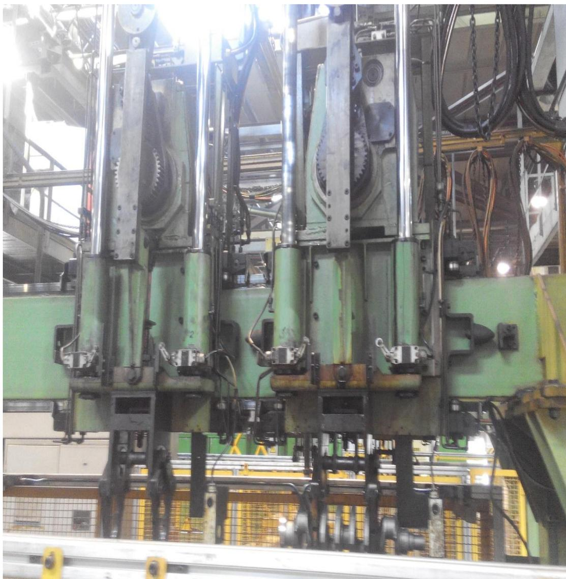
Рисунок 1.5 - Портальный манипулятор с 2мя параллельно работающими системами с одной грузонесущей рукой (вид со стороны схватов)
