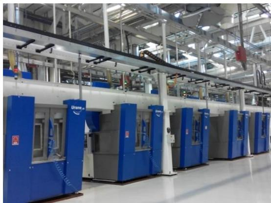
Рисунок 1-Технологическая цепочка станков, обслуживаемая одним манипулятором
