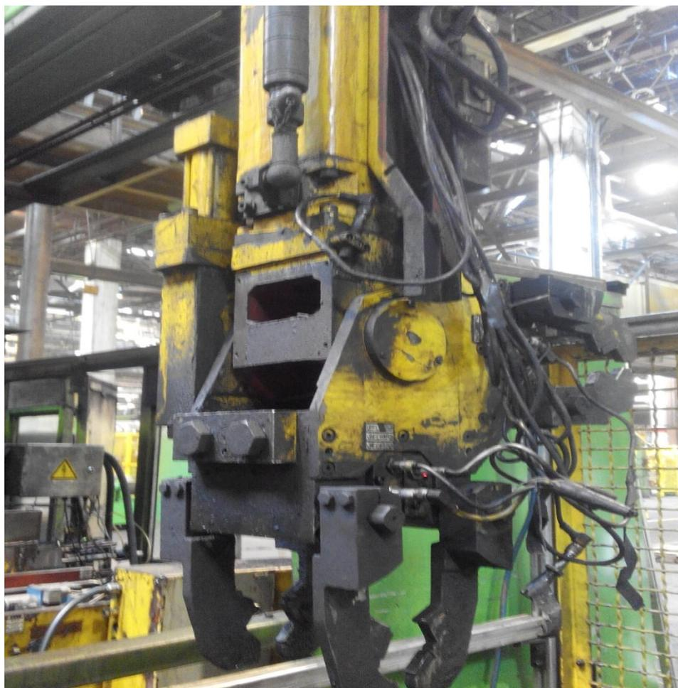
Рисунок 1.3 - Грейферная головка с гидравлическим приводом, на порталного манипулятора с одной грузонесущей рукой. GFM
