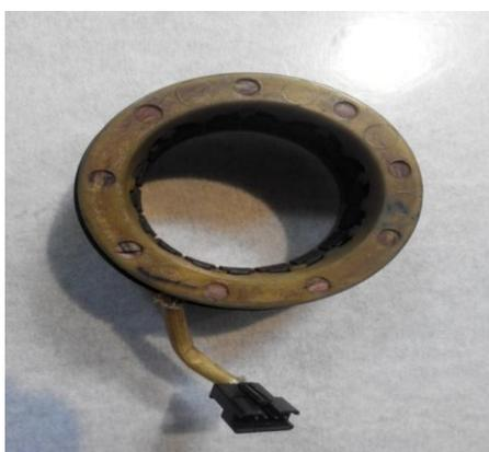
Рисунок 2.7- Тахогенератор электродвигателя серии 1 FT5
