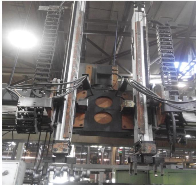
Рисунок 1.9 - Портальный манипулятор в составе технологического оборудования ПАО “АВТОВАЗ”
