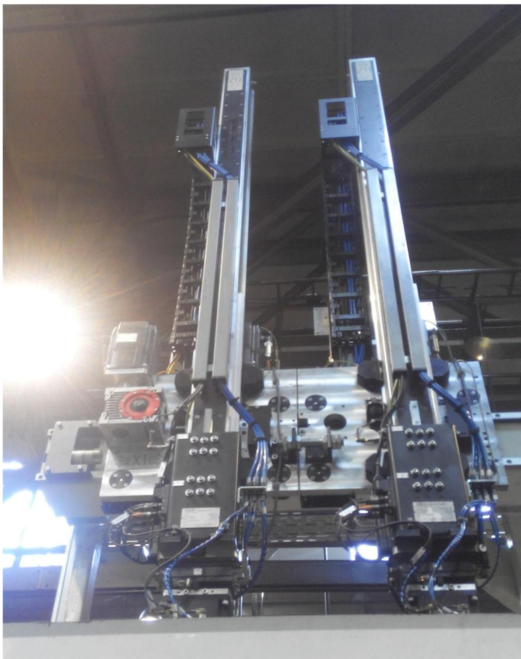
Рисунок 1.6 - Портальный манипулятор с 2мя грузонесущими руками и одной кареткой
