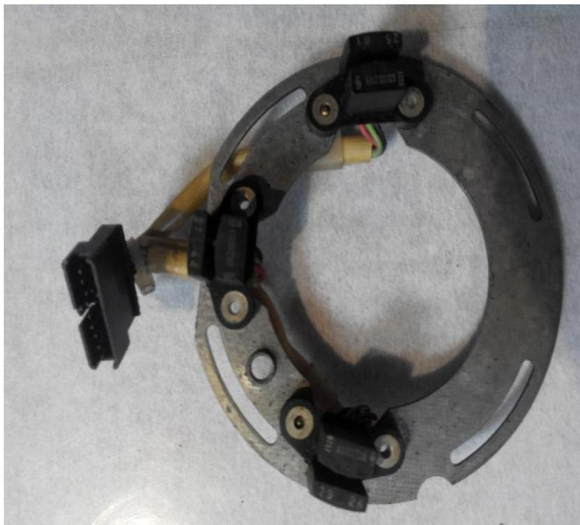
Рисунок 2.4 - Датчик положения ротора двигателя серии 1FT5
