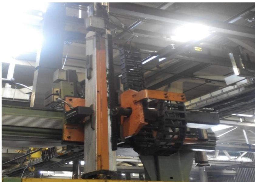
Рисунок 1.1 - Портальный манипулятор с одной грузонесущей рукой изготовленный ПТО «ОАО» АВТОВАЗ
