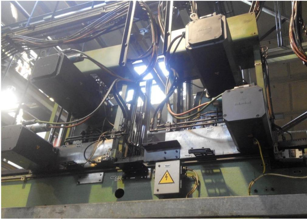
Рисунок 1.4 - Портальный манипулятор с 2-мя параллельно работающими системами с одной грузонесущей рукой (вид со стороны синхронных двигателей)
