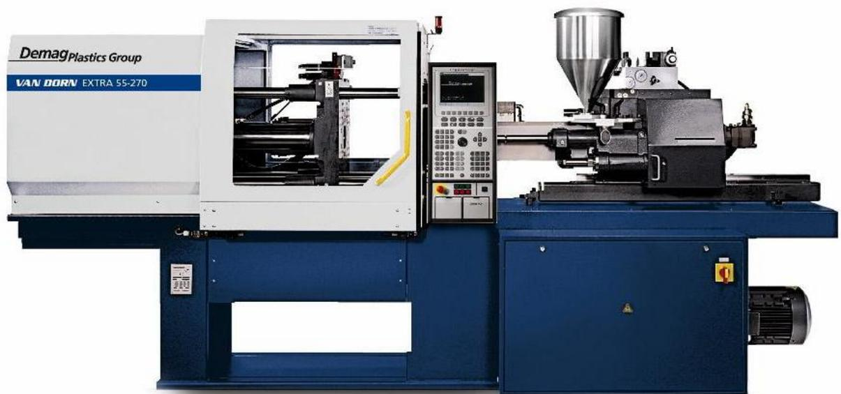
Рисунок 1 - Термопластавтомат с гидроприводом подачи расплава пластмассы
