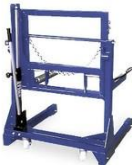
Рисунок 2.2 Монтажно-транспортная тележка WTA1 для работы с крупногабаритными колесами
