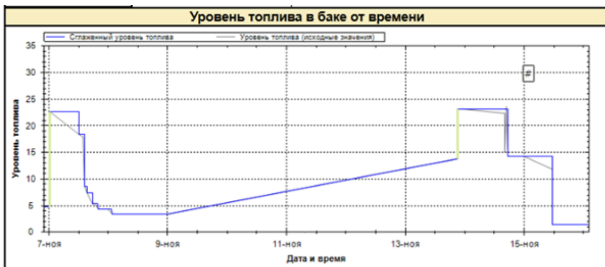
Рисунок 3.4 – ДУТ LLS неправильно настроен
