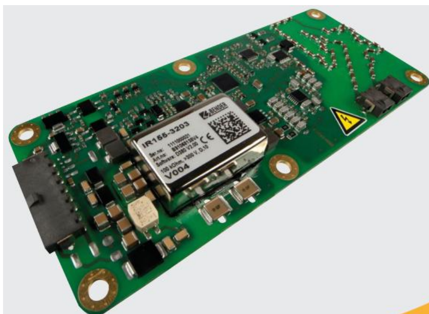
Рисунок 3.16 – Внешний вид устройства контроля изоляции
