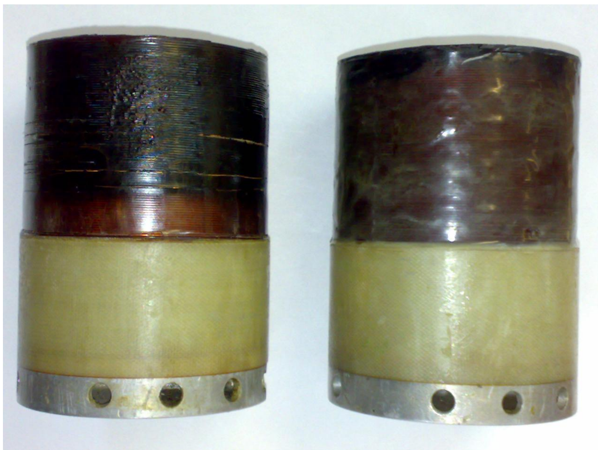
Рисунок 1.9 – Выгорание обмотки двигателя
