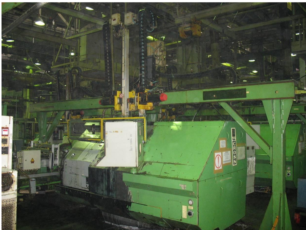
Рисунок 1.1 – Общий вид токарного станка Cross 2000 в составе поточной линии обработки поршня
