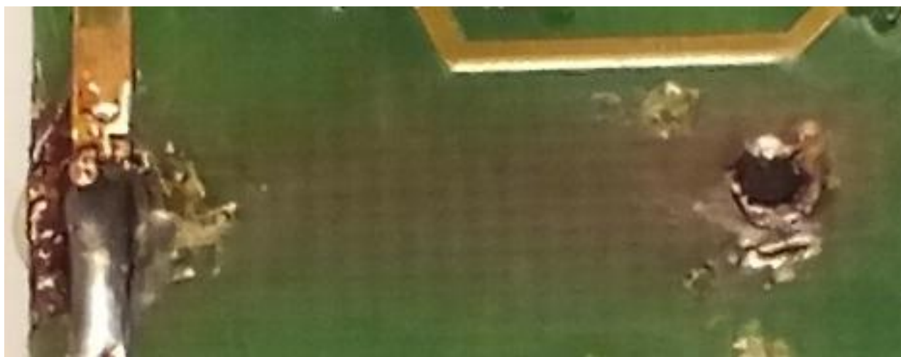
Рисунок 1.38 – Фотография платы, которая почернела от тепла выделяемого мощным резистором, работающем в предельном допустимом режиме
