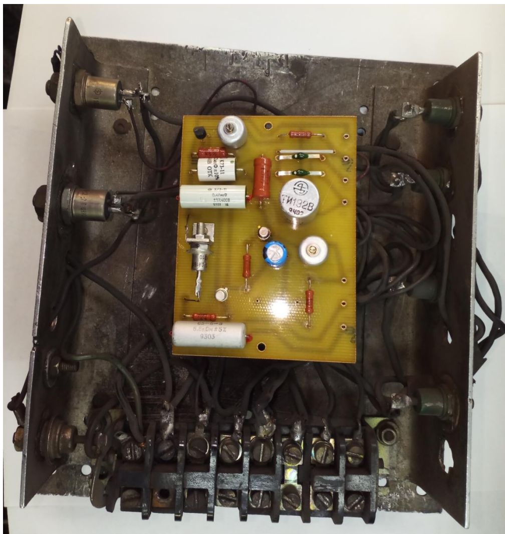
Рисунок 1.21 – Фотография системы управления электроприводом установки «РОБОТ», производство ВАЗ УГЭ ЛА
