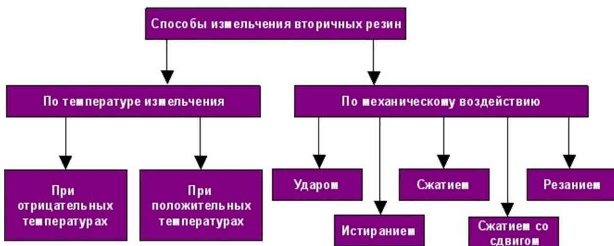
Рисунок 2. 4 - Способы измельчения шин
