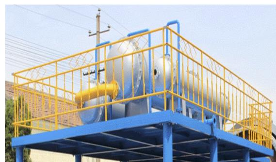
Рисунок 3.3 - Оборудование подачи измельченного материала в реактор; кожухотрубные конденсаторы
