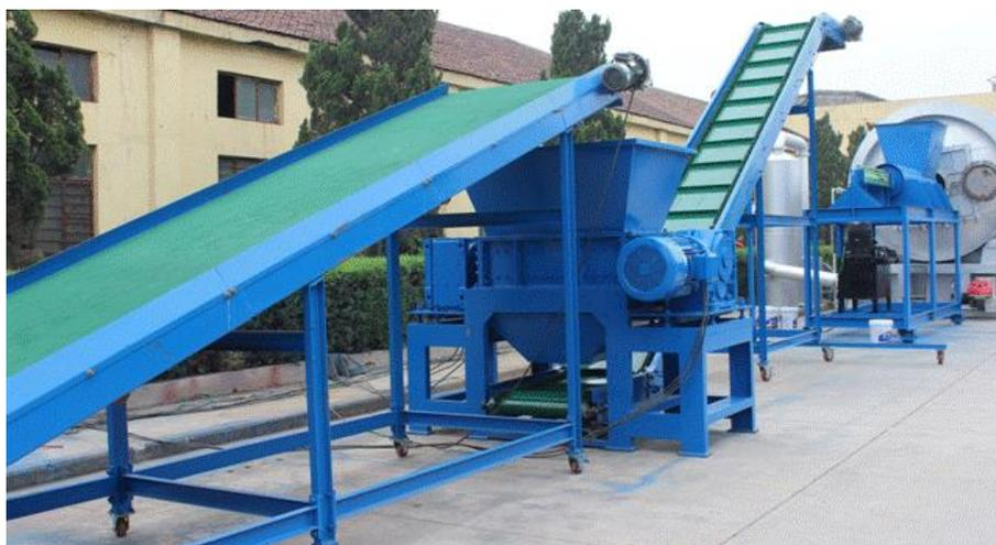
Рисунок 3.2 - Оборудование разделки, измельчения и подачи материала в реактор
