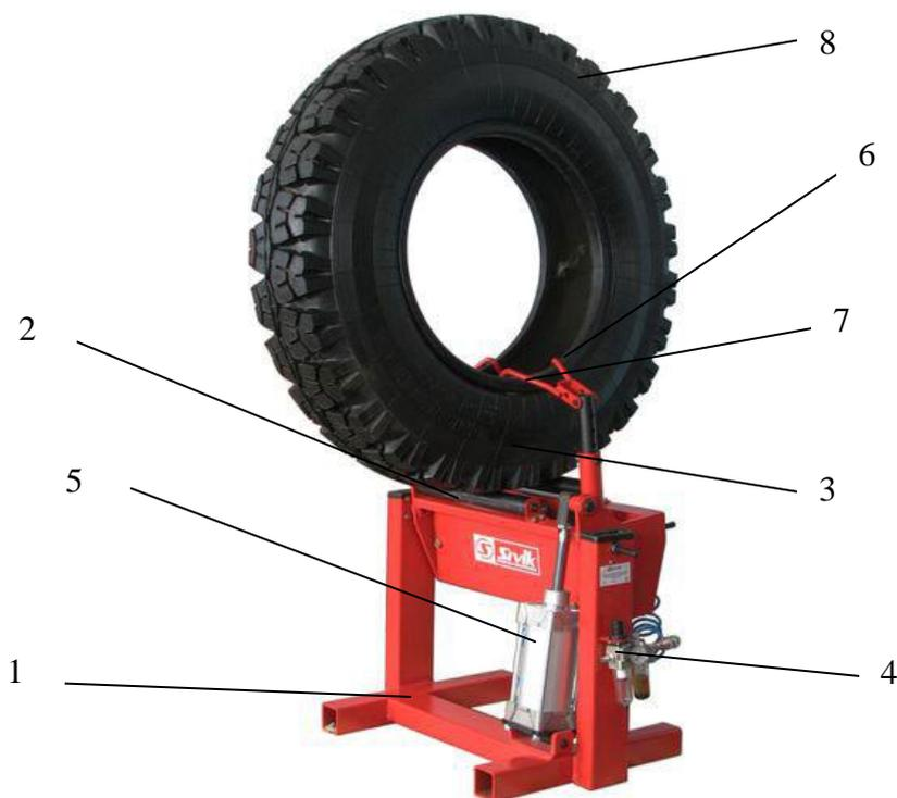
1-рама, 2-ролик опорный, 3-механизм для расширения бортов, 4-пневмоаппаратура управления, 5-пневмопривод, 6 – рычаг, 7 – захват, 8-шина
