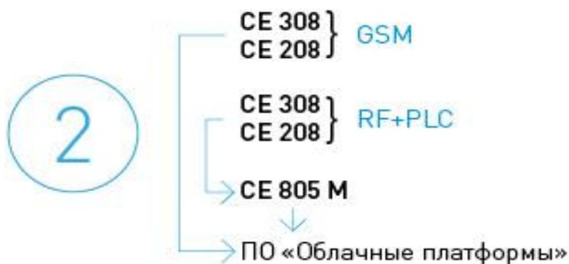
Рисунок 9 - Система на основе каналов связи «Радио + PLC – модуль» и «GSM/GPRS»
