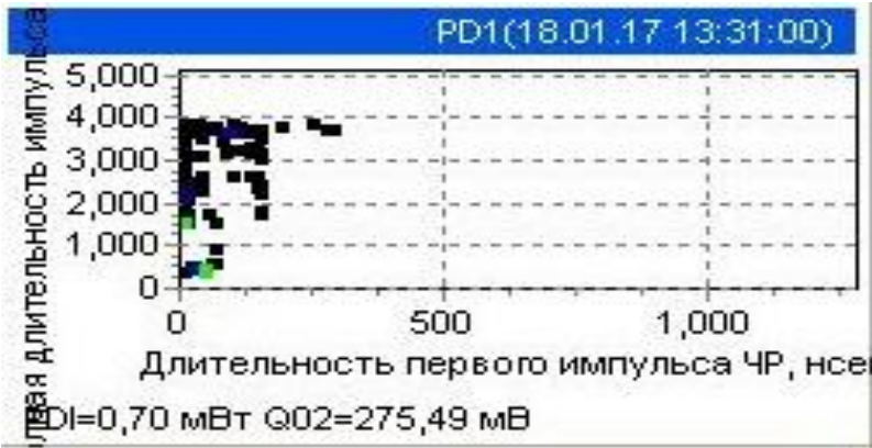
Рисунок 50 - TF-плоскость для кабельной линии В-300-II
