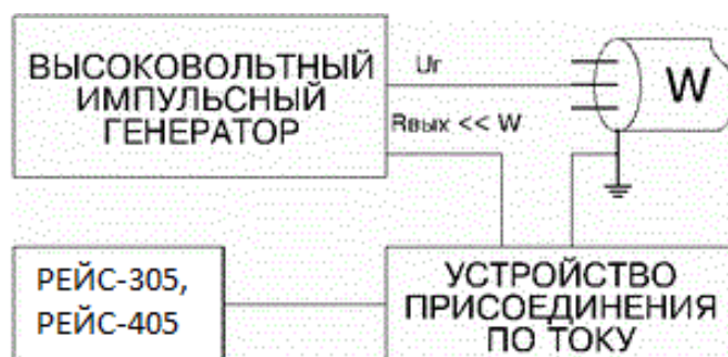
Рисунок 8 - Схема реализации волнового метода импульсного тока
