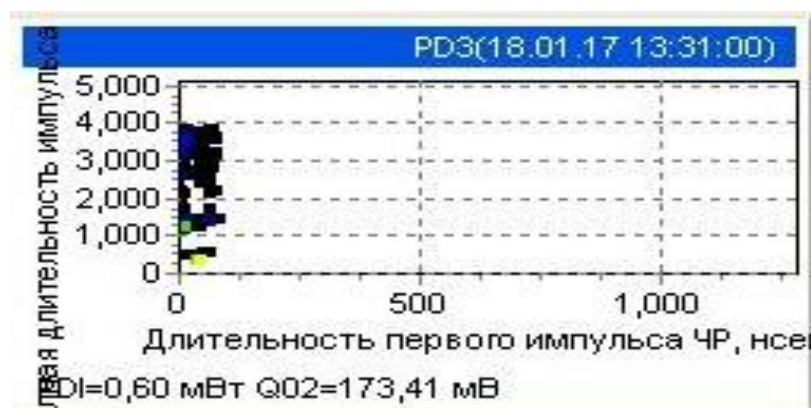
Рисунок 52 - TF-плоскость для кабельной линии КС-1-53
