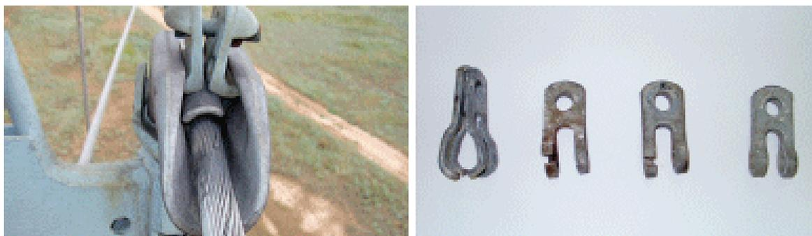
Рисунок 1.10 – Разрушение элементов ВЛ от пляски проводов
