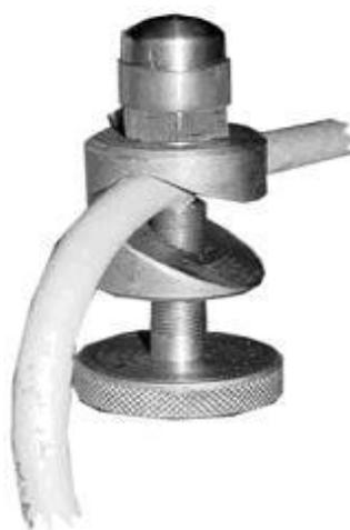
Рисунок 1.1 – Крепление виброакселерометра на трубке ТНВД
