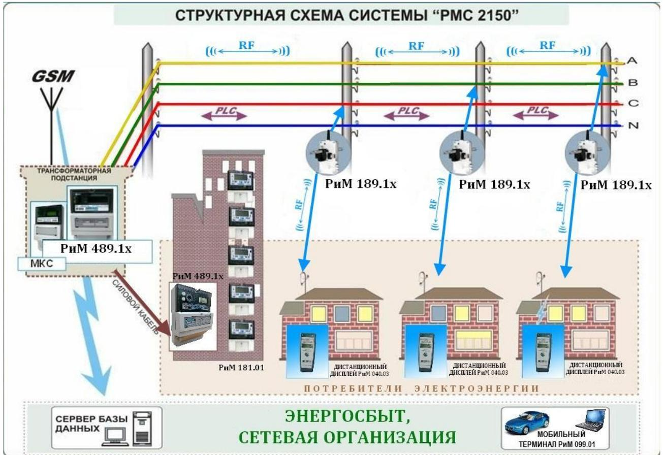
Рисунок 4 – Представление структурной схемы на базе РМС 2150-1
