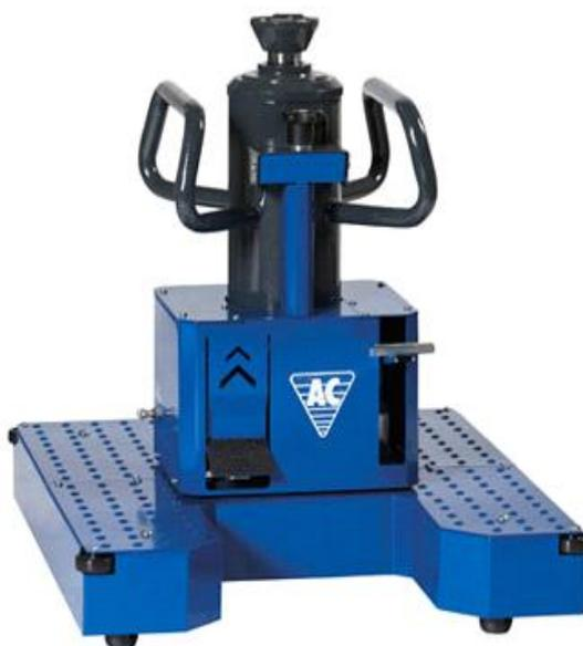
Рисунок 2.3 Передвижная стойка-гидроподъемник
