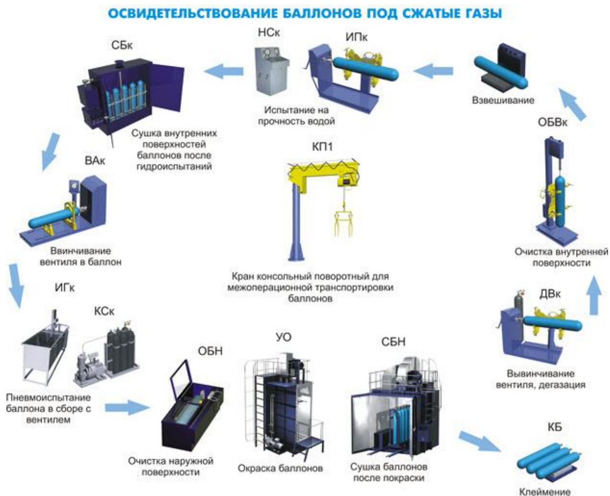
Рисунок 2.1 - Технологическая схема освидетельствования газовых баллонов
