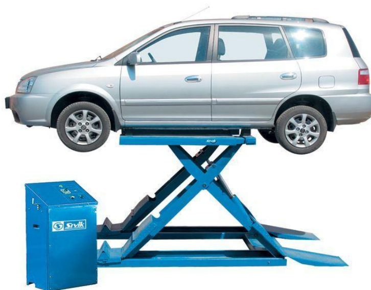
Рисунок 2.2 – Электрогидравлический подъемник Ермак-3000Н
