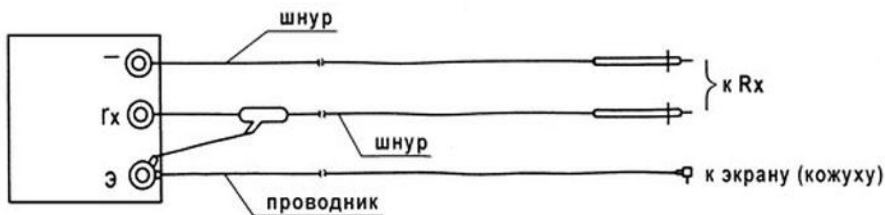
Рисунок 3.6 – Схема подключения щупов мегаомметра
