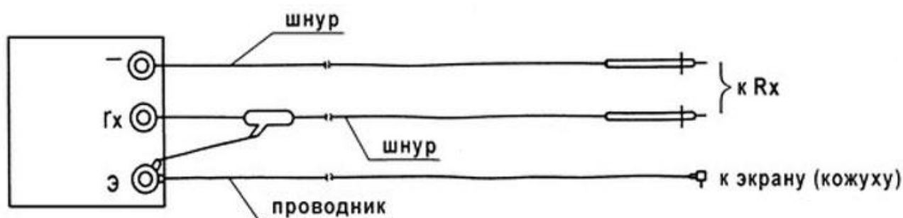
Рисунок 3.1 – схема подключения щупов мегаомметра.
